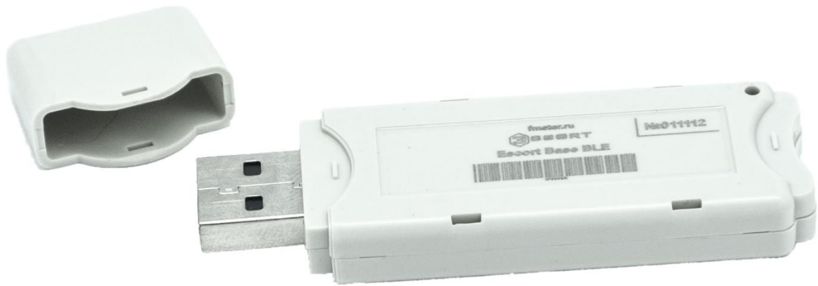
Рис.3.3. Конструкция конфигурационной базы беспроводного емкостного датчика уровня топлива BLE-BASE-USB
